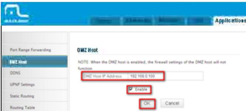
**DMZ Host IP Address:** O endereço de IP do aparelho o qual o firewall do roteador será desativado. Certifique-se de configurar estaticamente o endereço de IP desse aparelho para que esta função seja consistente.
