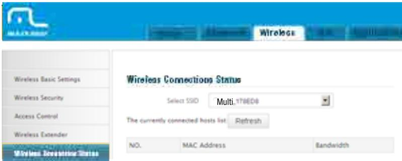
**Nota:** A banda larga aqui se refere ao canal de banda larga ao invés da conexão wireless.
