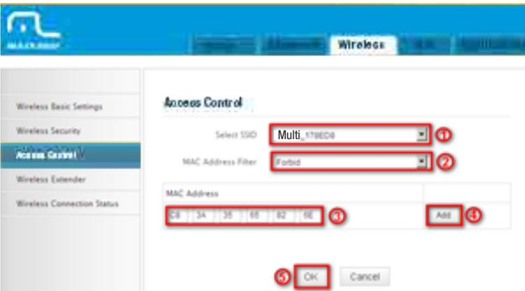
Passo1. Selecione um SSID, por exemplo, **Multilaser\_178ED8**.
